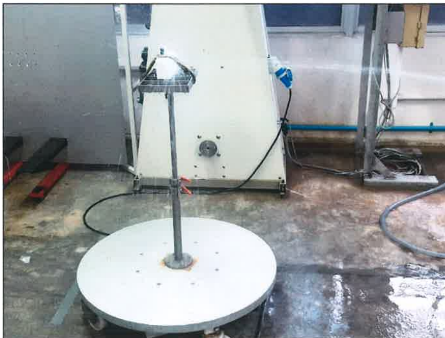
รูปที่ 5 การทดสอบน้ำ IPX5
