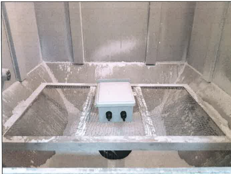
Photo No.4 : IP5X Dust test
