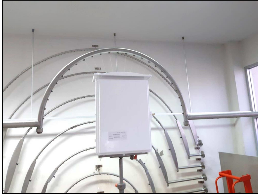
รูปที่ 5 การทดสอบน้ำ IPX4
