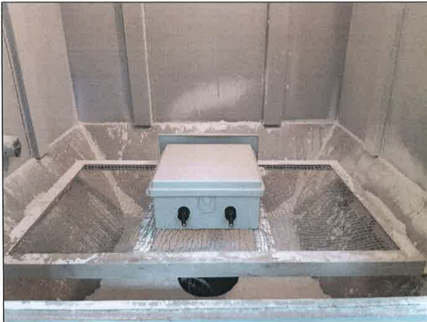
Photo No.4 : IP5X Dust test
